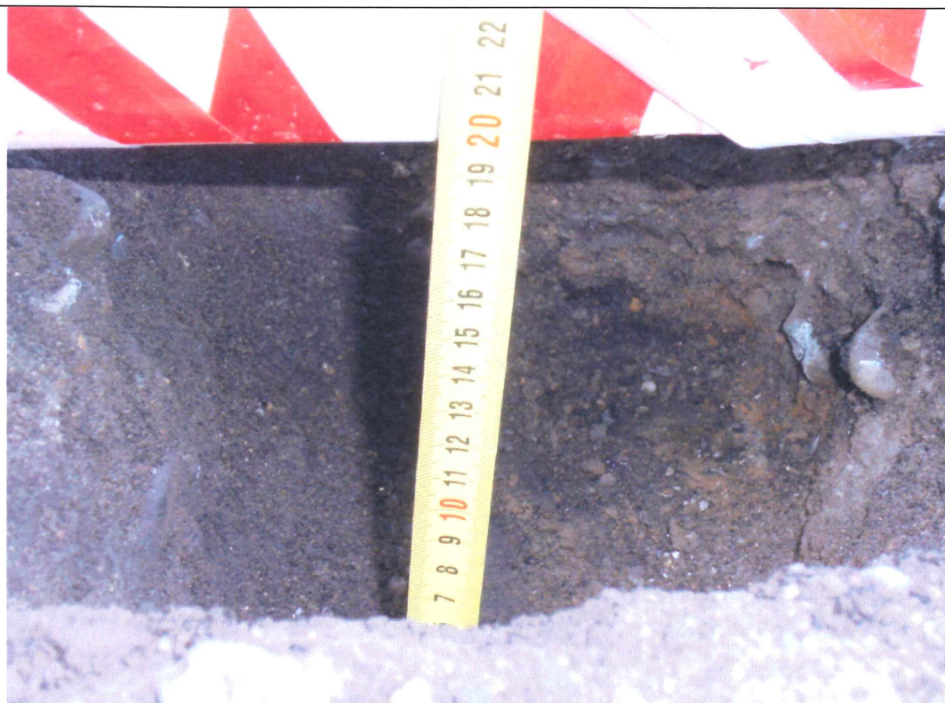
Obr. AS3-3 : Fotografie kopané sondy č. 3 po odběru materiálu druhé vrstvy v předpokládané mocnosti.
