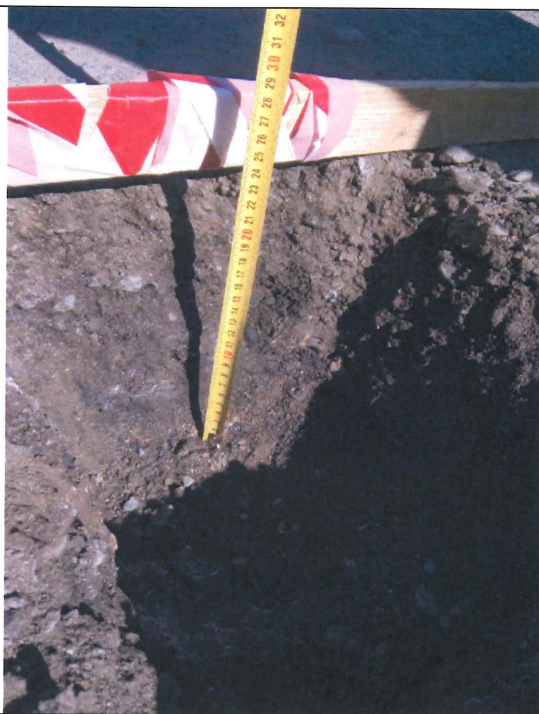
Obr. AS1 -2 : Fotografie kopané sondy č. 1 po odběru materiálu druhé vrstvy.
