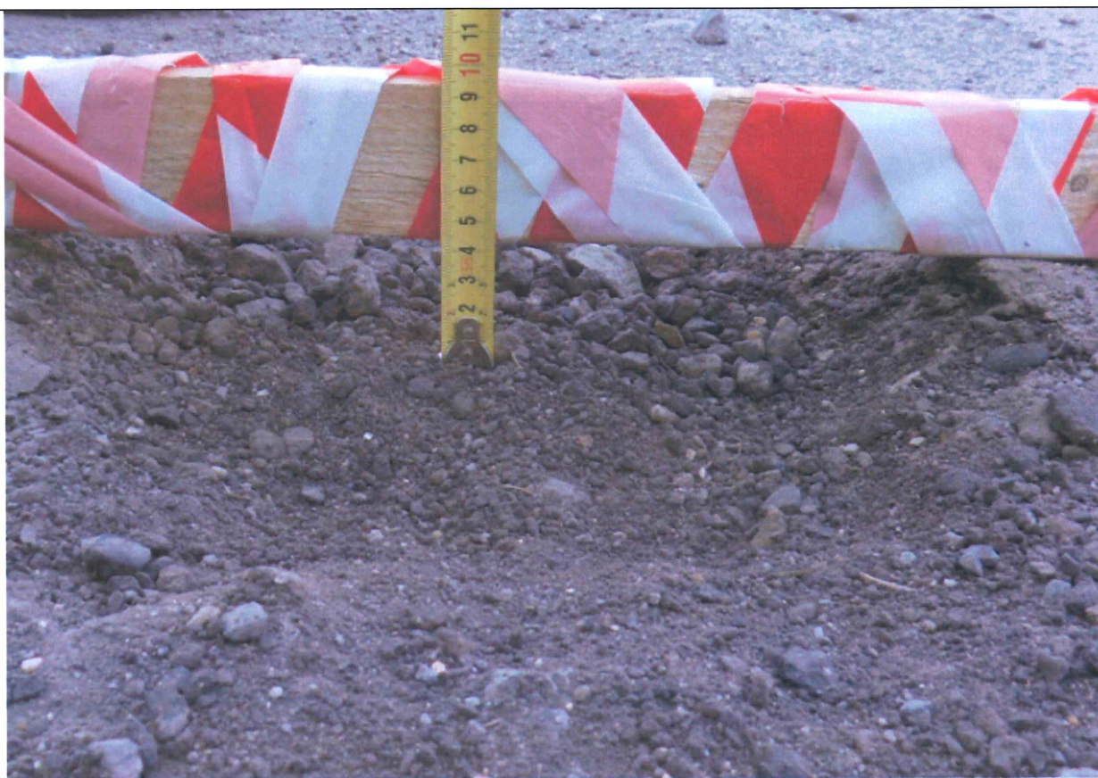
Obr. AS3-2 : Fotografie kopané sondy č. 2 po odběru materiálu první vrstvy.
