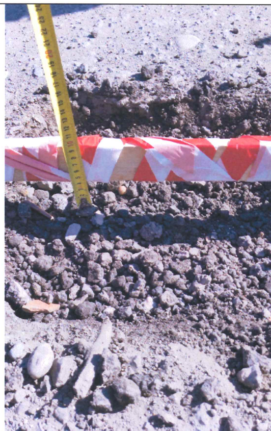
Obr. AS1 -2 : Fotografie kopané sondy č. 1 po odběru materiálu první vrstvy. Materiál obsahuje nevhodné složky (recyklát z pálených cihlářských výrobků, těžené kamenivo)
