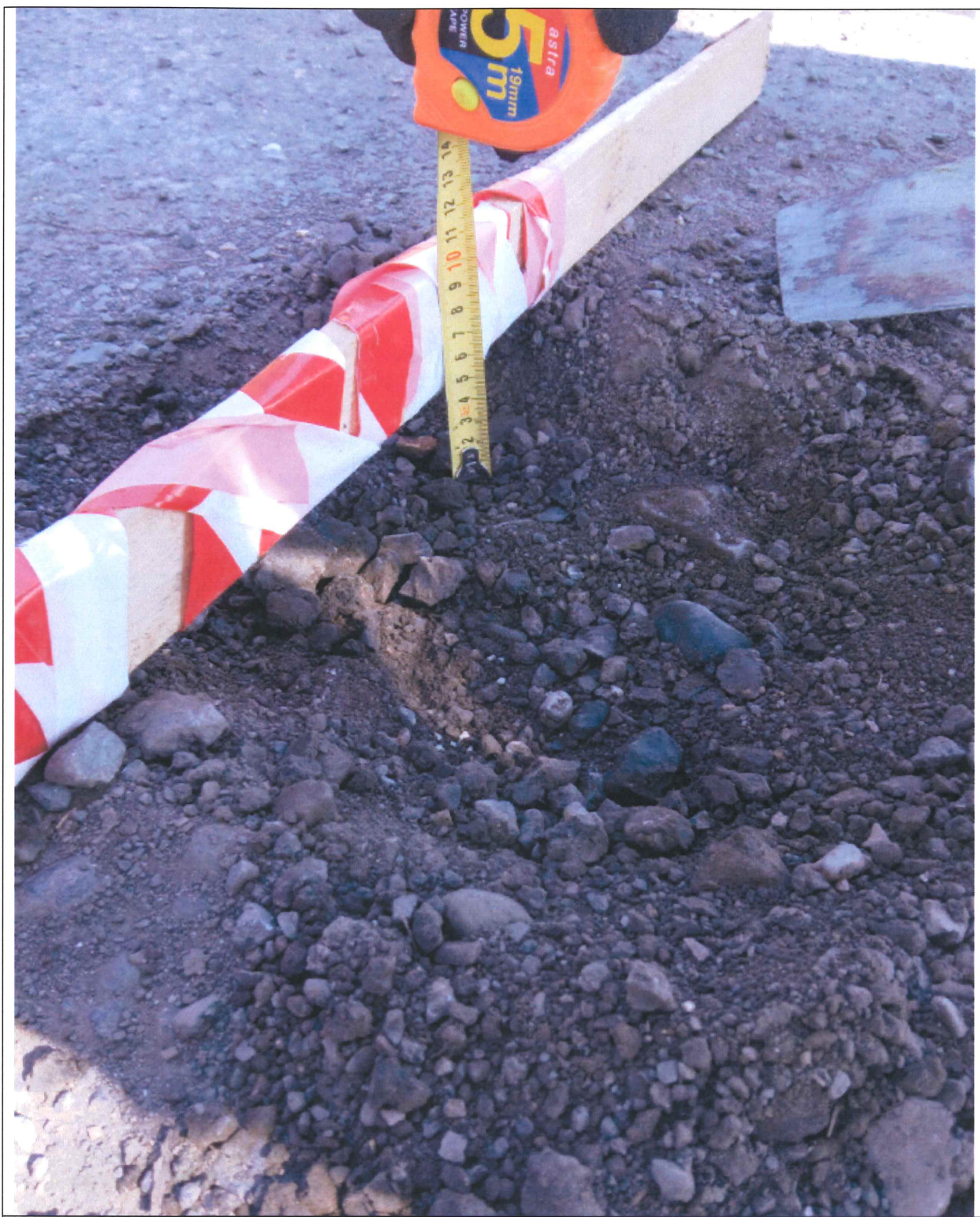
Obr. AS2-2 : Fotografie kopané sondy č. 2 po odběru materiálu první vrstvy.
