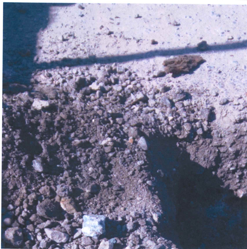
Obr. AS1-4 - Fotografie kopané sondy č. 1 po odběru materiálu druhé vrstvy. Materiál obsahuje nevhodné složky (části kůry stromů)
