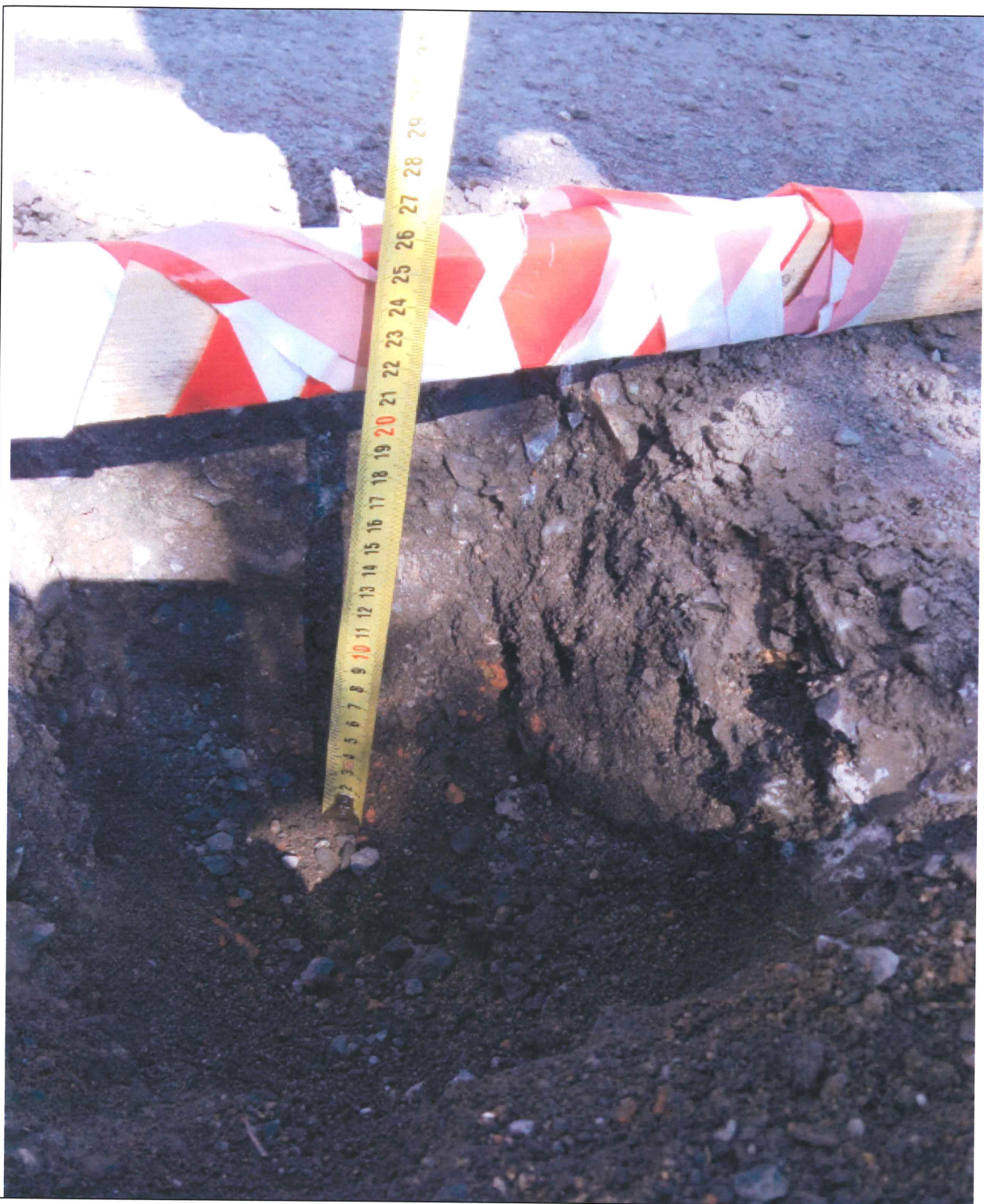
Obr. AS2-3 : Fotografie kopané sondy č. 2 po odběru materiálu druhé vrstvy v předpokládané mocnosti.
