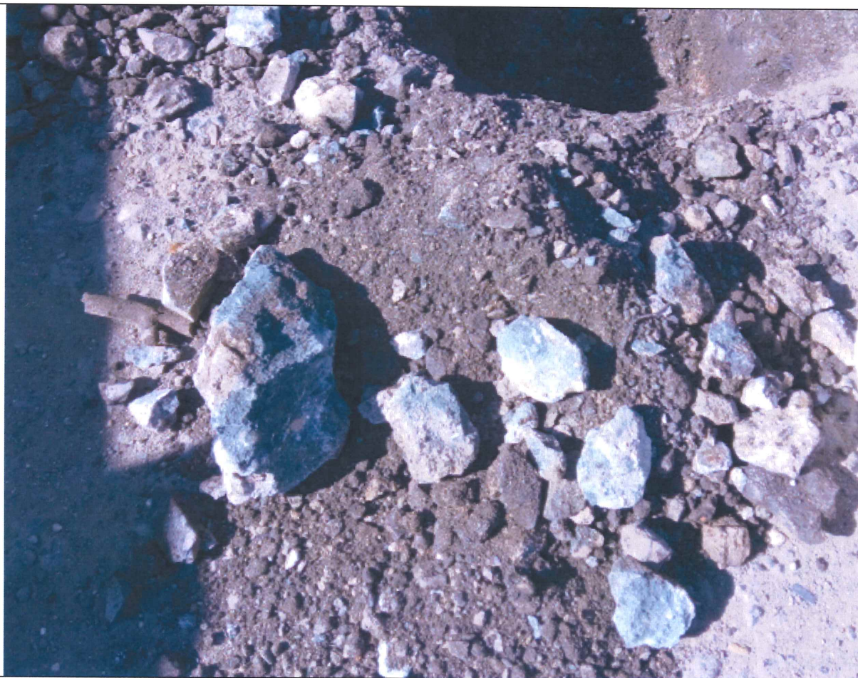
Obr. AS1 -3 : Fotografie kopané sondy č. 1 po odběru materiálu druhé vrstvy. Materiál obsahuje nevhodné složky (zbytky větví, betonový recyklát)
