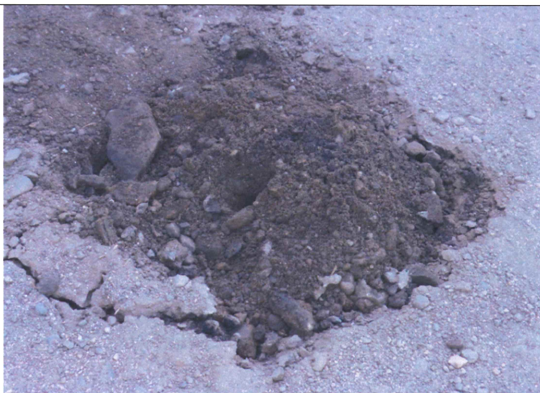
Obr. AS3-4 : Fotografie kopané sondy č. 3 při odběru materiálu první vrstvy. Materiál obsahuje nevhodné složky (Zrna kameniva s frakcí větší než 32mm)
